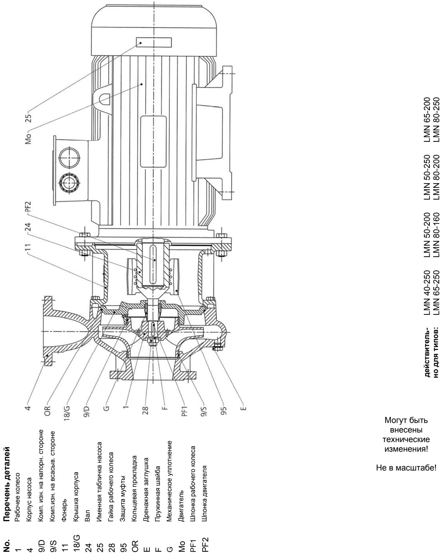
**Разрез насоса LM – Конструкция для двигателя до 4 кВт**
